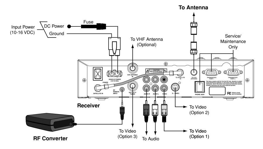
**System Wiring Diagrams**
